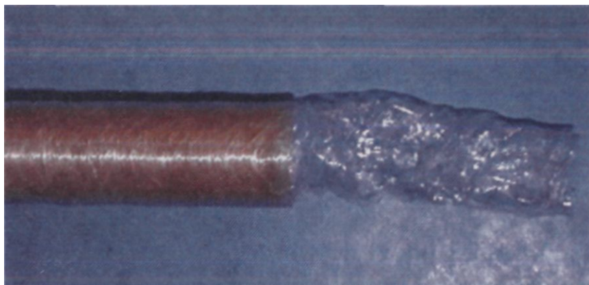
Рис. 28. Полупроницаемая целлюлозная трубчатая мембрана марки ТУ-606.
